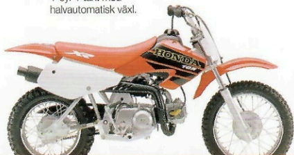
XR 70R. 1-cyl 4-takt med halvautomatisk växl.
