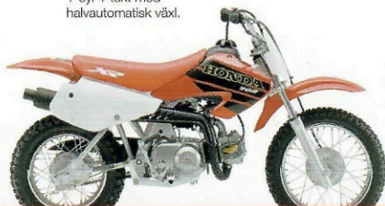
XR 70R. 1-cyl 4-takt med halvautomatisk växl.
