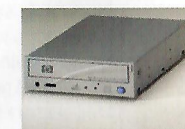
FIGUR 12. Denna externa DVD-brännare från HP ansluts via FireWire-anslutning då den kräver extra hög datahastighet. De modeller som monterar i datorn ersätter cd-spelaren. Den interna förbindelsen är snabb så det räcker. Foto: HP.
