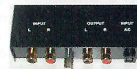
FIGUR 7. Den här är en gramfonförstärkare som kan hantera de svaga signalerna från pickuppen. Egentligen kallas den för RIAA-förstärkare. RIAA står för Recording Industry Association of America, vilka har satt normerna för lp. Denna tonkurva finns i alla moderna gramfonförstärkare.
