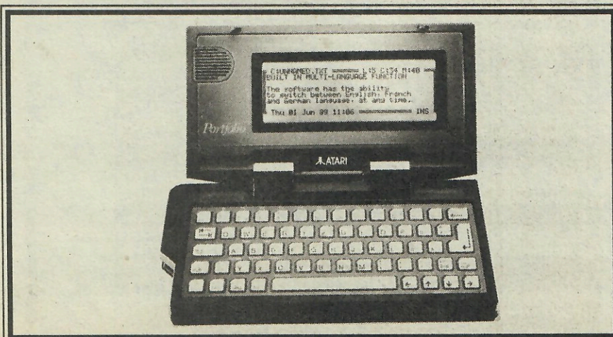
Portfolion är en MS-DOS dator med 256 Kb i ROM och 128 Kb i RAM. Lagringsmedium är kreditkortsstora minnesmoduler som sticks in från datorns sida
