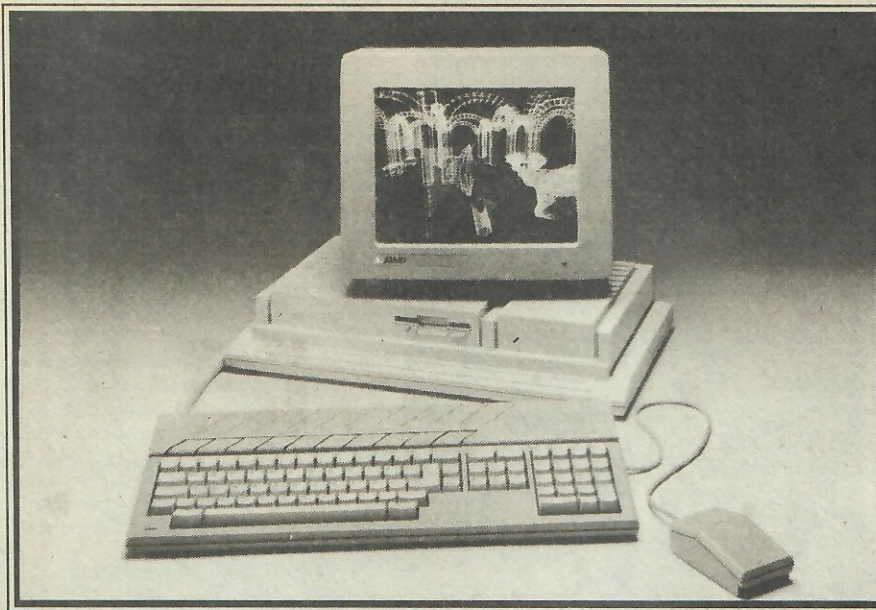
Atari TT har en 32 bitars processor med 16 Mhz och är helt kompatibel med befintlig ST-programvara
