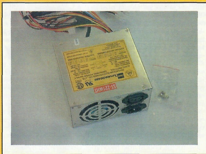
Nätdelen föremontering. Ett antal olika kablar finns för anslutning av flera diskdrivare och andra strömförbrukare.
