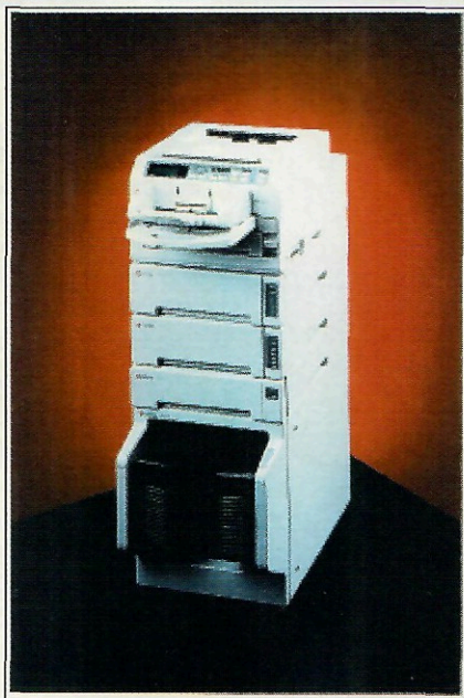
Kyocera Ecosys FS-1500 skriver 10 sid/min, här fullt utbyggd med två st extra pappersmagasin, kuvertmatare, duplexenhet samt 15-facks sorterare
