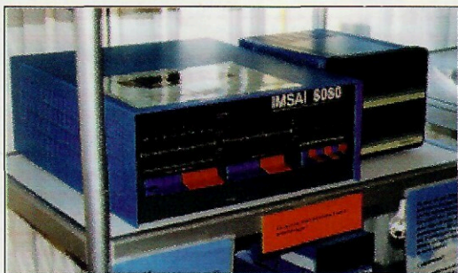
Imesai 8080 är en dator liknande Altair. Observera switcharna med vars hjälp inmatning av data sker
