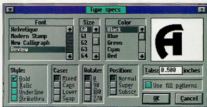
Bilder: T.v.: Med denna meny väljer du stil, stilstorlek, färg, rotering av text, position mm. Övan: I Measurements ställer du in måttenheter för hela dokumentet. I detta fall har vi valt mm.
